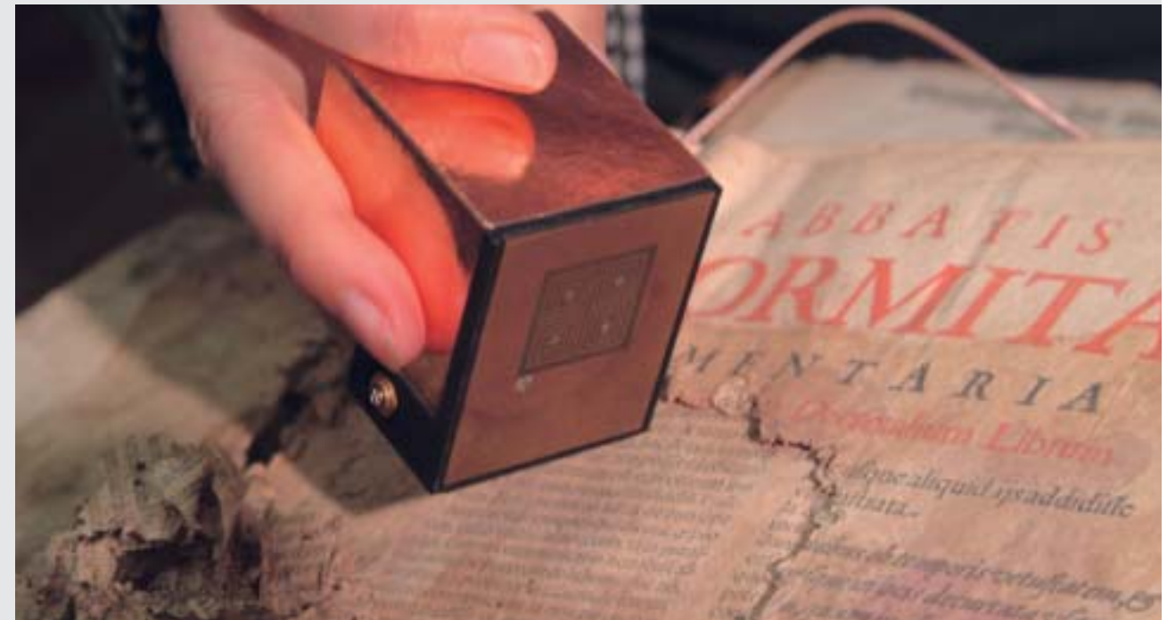
Handliche Messungen: Mit der „NMR-Mouse“ können auch der Erhaltungszustand altertümlicher Fresken und vom Verfall bedrohter Bücher geprüft werden.
