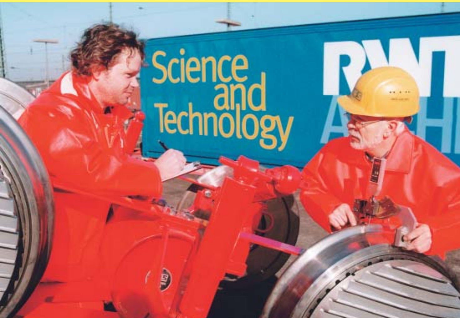
Am Institut für Schienenfahrzeuge und Fördertechnik wird derzeit auch an Hochleistungsfahrwerken für den ICE geforscht – hier das Einzelrad-Doppelfahrwerk EDF.
