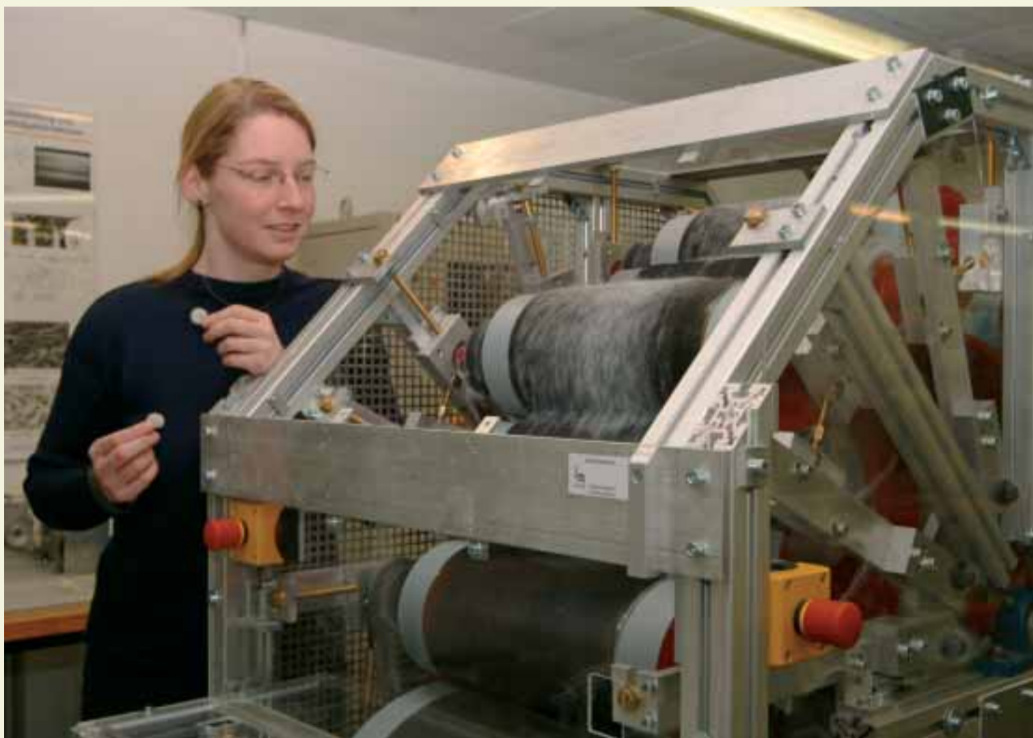
Dipl.-Ing. Ute Wiesemann bereitet eine Labor-Krempelmaschine für einen Versuchsdurchgang vor. Die runden Vliesproben sind aus Polyesteramid und lösen sich im Körper auf. Eingesetzt werden sie bei der Gewebeherstellung z.B. für Muskeln, Harnleiter oder Kieferknochen. Gezüchtet werden die Gewebe von den Forschungspartnern im Universitätsklinikum.
