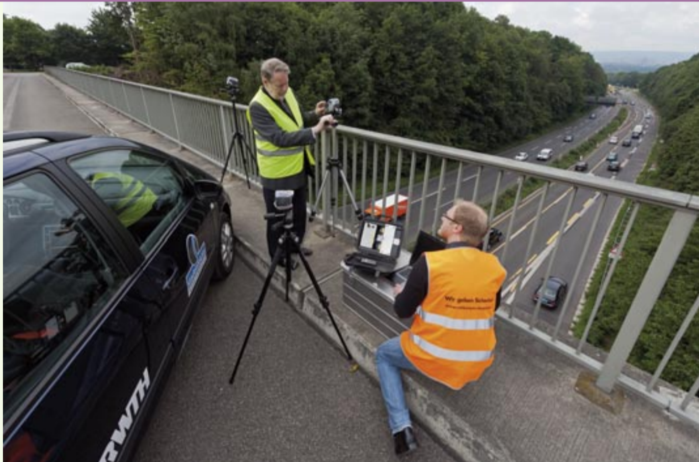
Die Beobachtung des Verkehrsflusses auf Autobahnen mit optischen Erfassungssystemen kann Staus verhindern und Menschenleben retten. Das Foto zeigt Professor Bernhard Steinauer und Ingenieur Tobias Volkenhoff vom Institut für Straßenwesen bei der Installation der Kameras.
