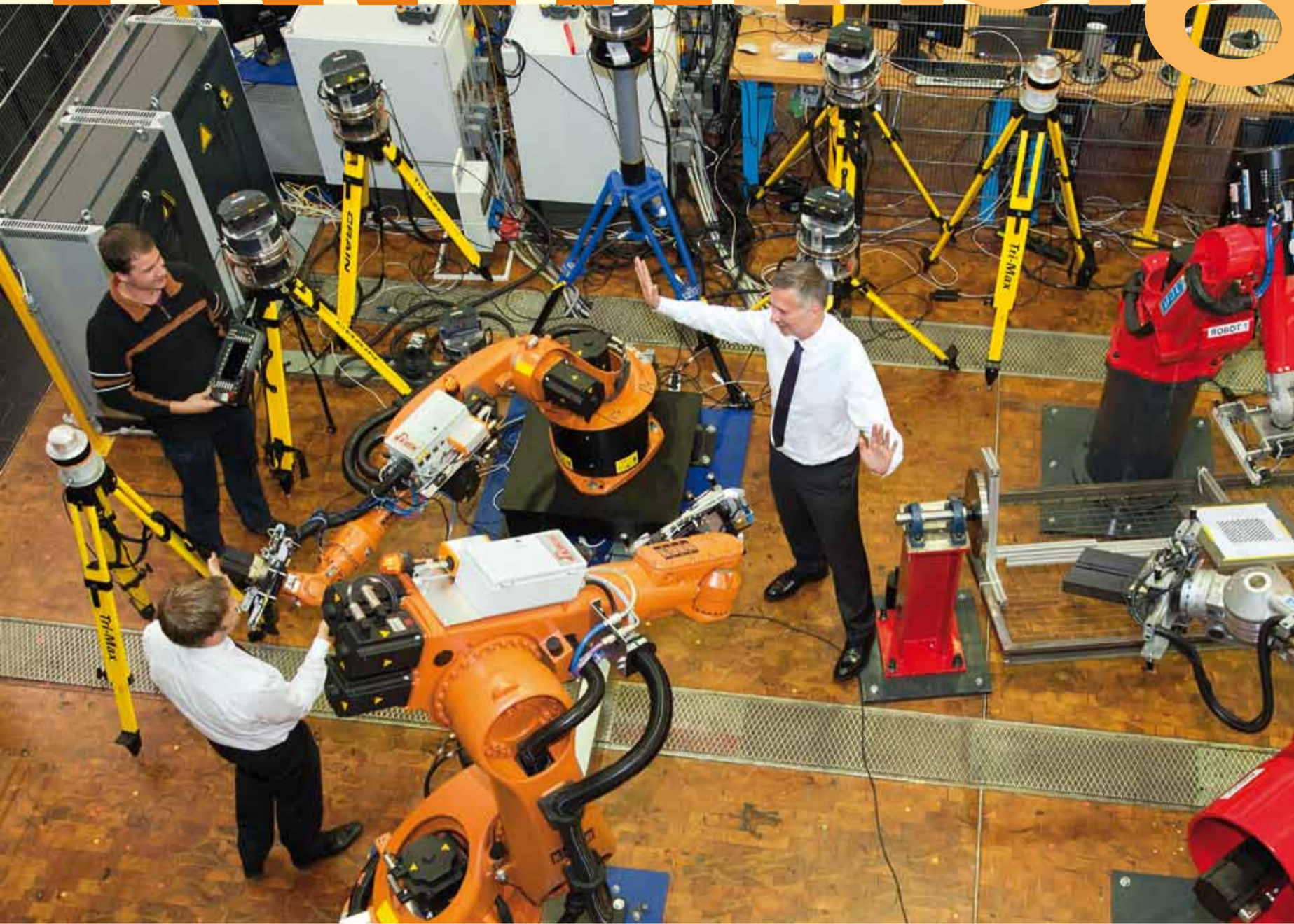
Im WZL der RWTH wird mit Unterstützung durch die Exzellenzinitiative ein neues System kooperierender Roboter für eine wandlungsfähige, zukünftige Produktion entwickelt. Foto: Peter Winandy
